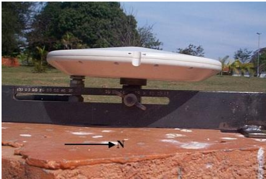
Fig. 2 - Peça de simulação de deslocamento instalada no pilar EP-UNESP-02.
